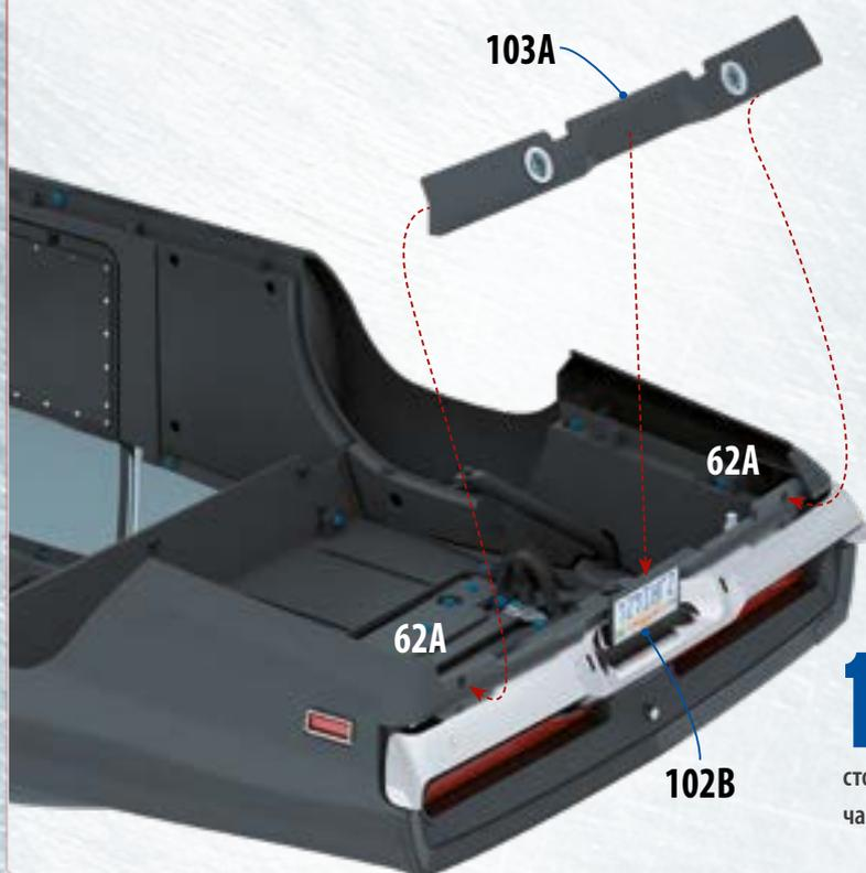
**103.5** **ОСТОРОЖНО** переверните корпус и положите его на рабочую поверхность. Установите деталь **103А** на внешней стороне задней части кузова **62А**. Обратите внимание, что средняя часть детали **103А** должна зайти за номерной знак **102В**.
