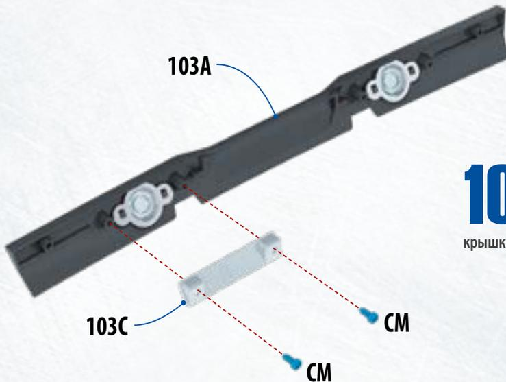
**103.3** **ЗАКРОЙТЕ** правый фонарь заднего хода крышкой **103C**, установив ее на задней юбке **103A** так, как показано на фотографии. Закрепите крышку двумя винтами **SM**. ◀
