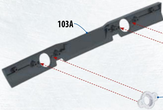
**103.1** **СОЕДИНИТЕ** корпуса фонарей **103D** с нижней юбкой **103A** так, как показано на фотографии (крепежные отверстия деталей должны совпасть). ◀
